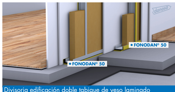
Divisoria edificación doble tabique de yeso laminado
