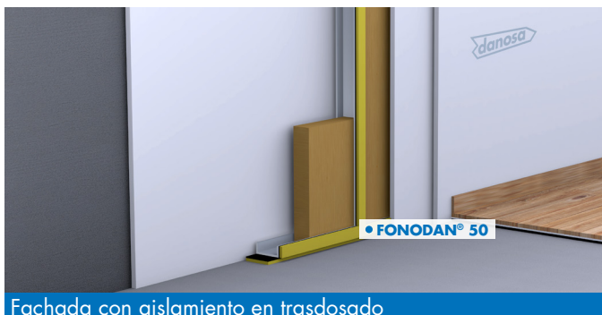
Fachada con aislamiento en trasdosado
