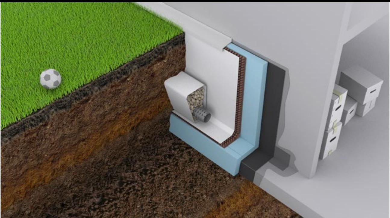
Los **SISTEMAS DE ESTRUCTURAS ENTERRADAS DANOSA** son soluciones integrales de impermeabilización, aislamiento, protección y drenaje de las estructuras enterradas en contacto con el terreno natural.
