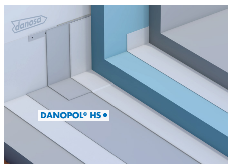
Solera sobre terreno compactado
